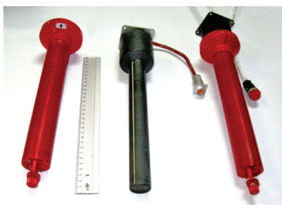
Рис. 3. Хвильовий зонд для прямих вимірювань густини просторового струму в іоносферній плазмі
