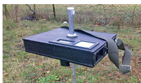
Рис. 4. Технологічний комплекс для електромагнітної оцінки стану й динаміки геологічного середовища: а) апаратура методу зондувань становленням електромагнітного поля; б) прилад методу природного імпульсного електромагнітного поля Землі; в) система збору геофізичних даних; г) система передачі даних GSM каналом
